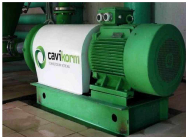
Рисунок 3.2 – Роторний подрібнювач-диспергатор «РІД-2»
