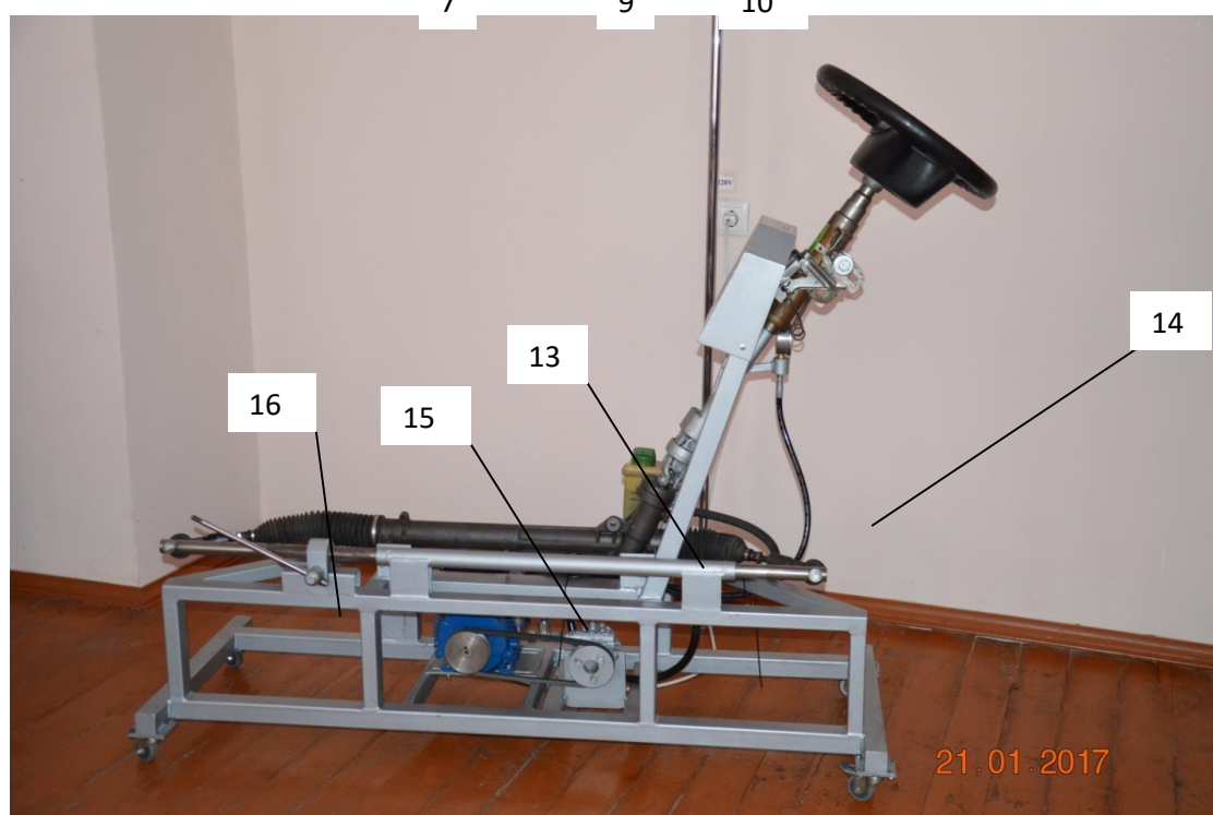
Рис. 3.4. Лабораторний стенд для дослідження роботи гідро підсилювача керма автомобіля
