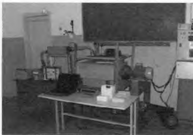
Рисунок 3.2 – Загальний вигляд вібраційної сушарки для фільтраційно-конвективного сушіння високовологого насіння
