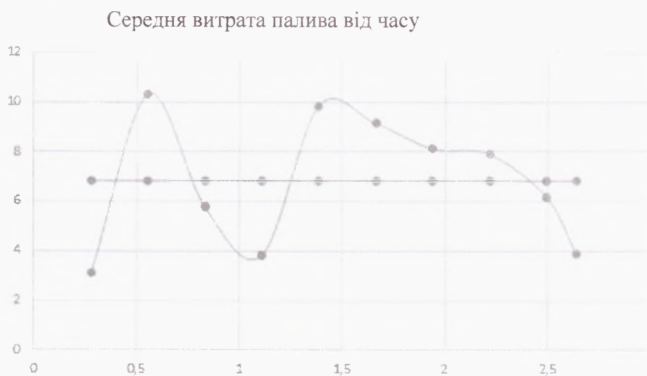
Рисунок 3.5 - Результати дослідження витрати палива ТЗ на дослідних дільницях в межах відстані шляху: а - в залежності від відстані шляху; б - в залежності від часу руху
