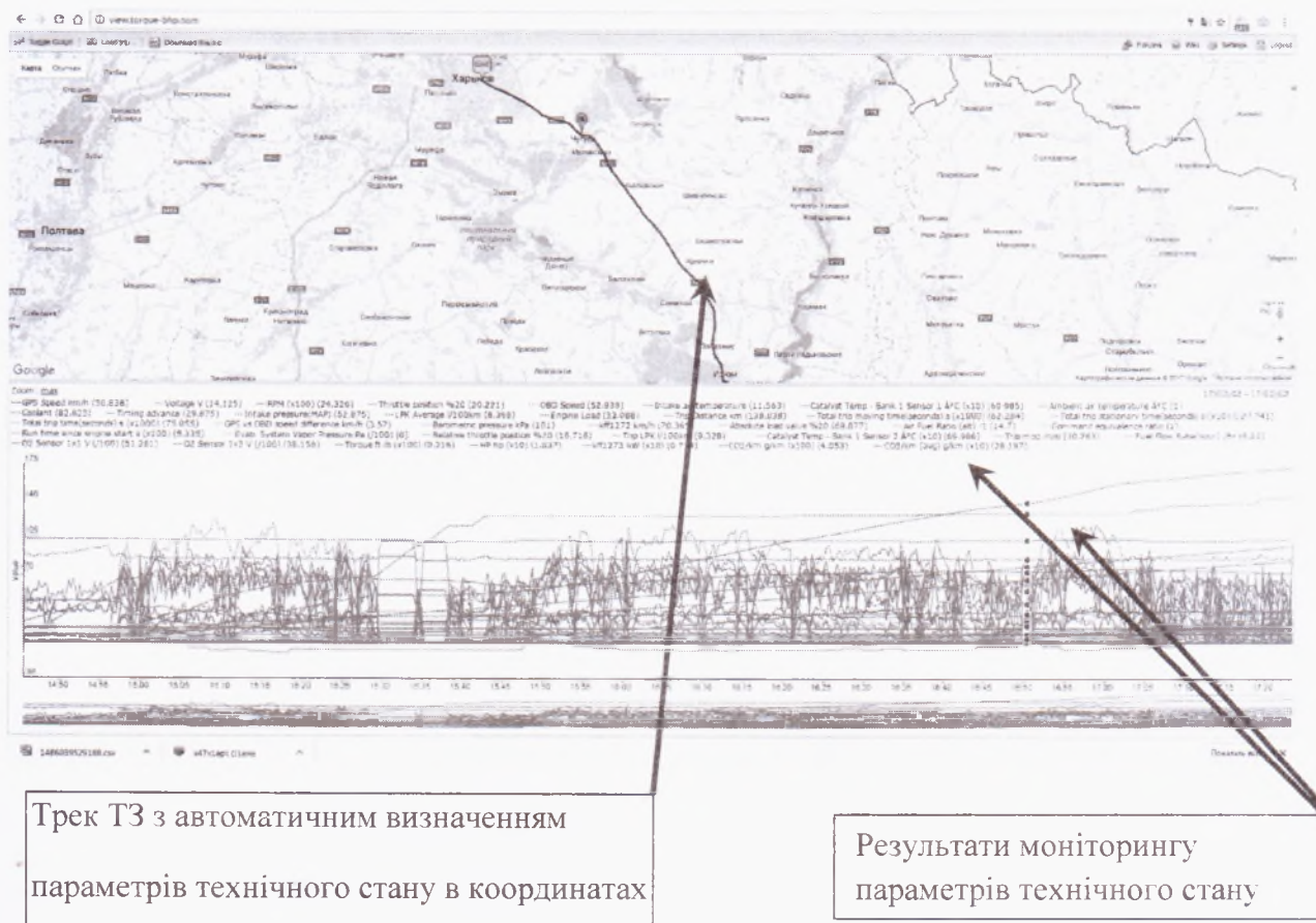
Рисунок 3.3 - Робоче вікно Torque з параметрами моніторингу параметрів технічного стану ТЗ
