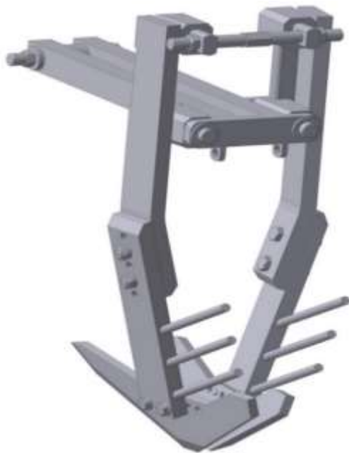
Рис. 3.2. – Загальний вигляд вібраційного викопувального робочого органу:
