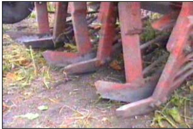
Рис. 3.3. – Дослідні зразки вібраційних викопувальних робочих органів.
