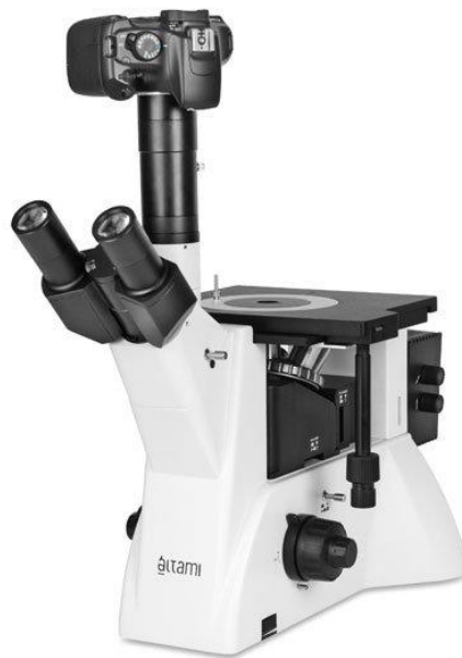
Рисунок 2.3 – Мікроскоп Альтами МЕТ1с
