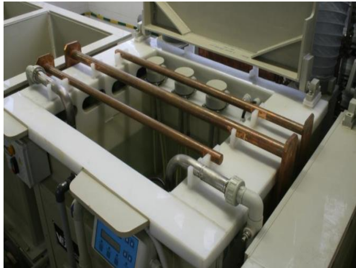
Рисунок 2.5 – Установка для гальванічного хромування
