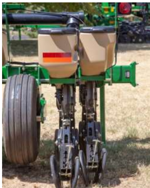
Рисунок 1.2 - Г) Здвоєні висіваючі секції сівалки Great Plains YP-825A
