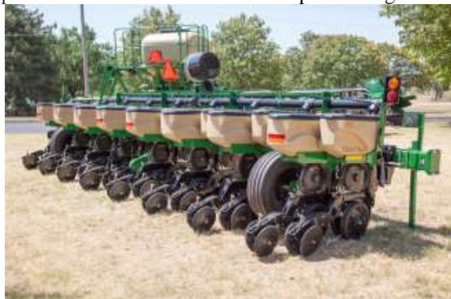
В) - Причіпна 8-рядна сівалка для пропашних культур Yield-Pro® YP-825A з можливістю сівби в здвоєний рядок
