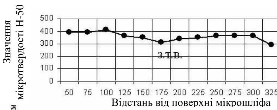
Рис. 2.6 Мікротвердість в зоні термічного впливу між шліцами
