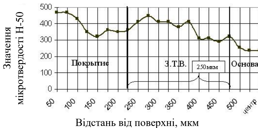
Рис. 2.4 Розподіл мікротвердості по боковій поверхні шліца після нанесеного покриття, мкм
