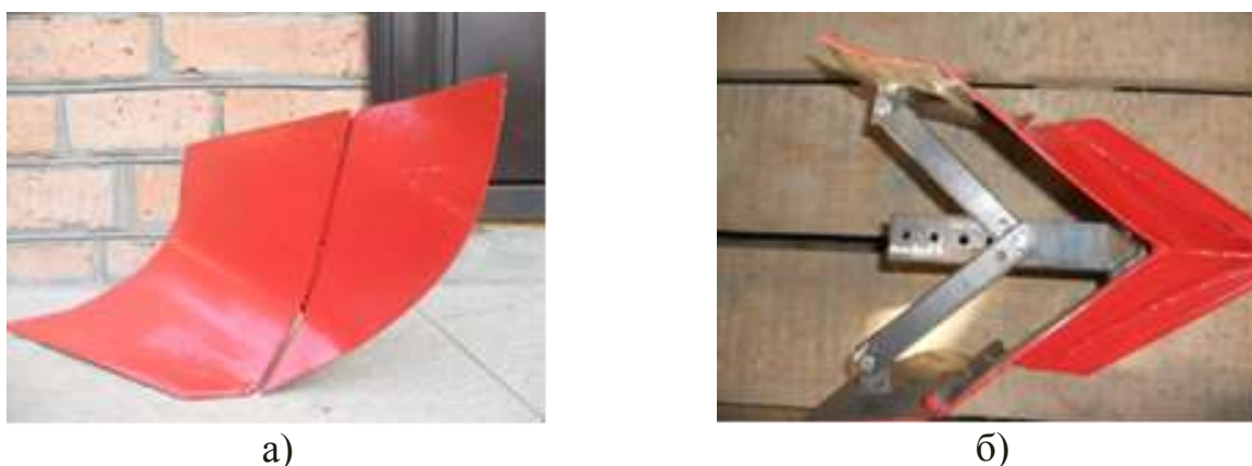
Рисунок 3.1 - Схема універсального сошника: а – вигляд збоку; б – вигляд зверху
