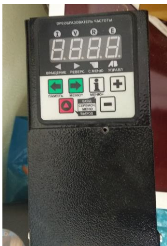
Рис 3.1 – Частотний перетворювач CFM 210
