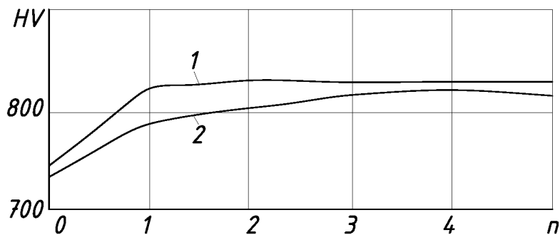
Рисунок 2.7 - Поверхнева твердість зразків із загартованої сталі ШХ15 в залежності від тиску і числа проходів
