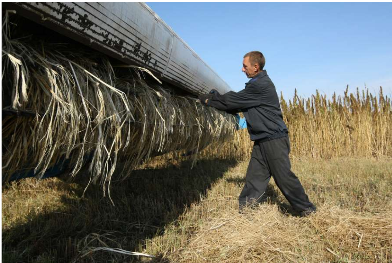
Рис. 2.3. Намотування стеблової маси коноплі на робочі органи мотовила зернозбирального комбайна
