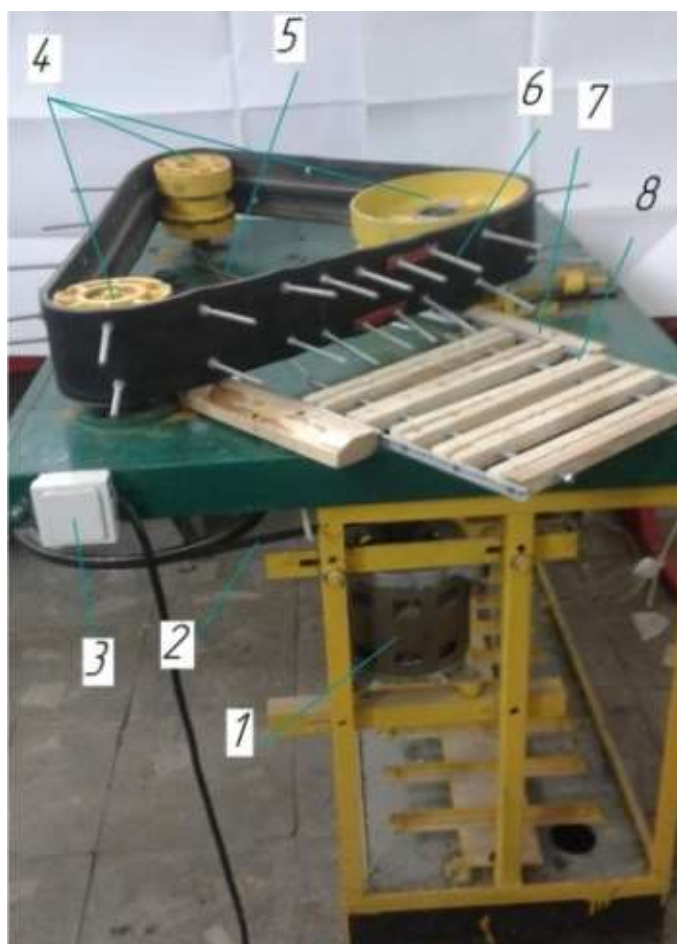
рис. 3.4. Експериментальна установка для дослідження збирання стебел конопель
