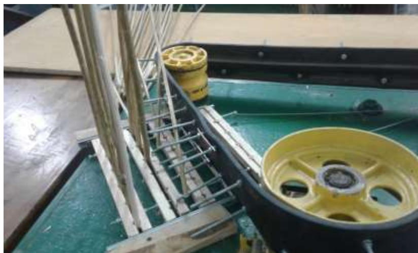
Рис. 3.6. Злам стебел при послідовному розташуванні пальців
